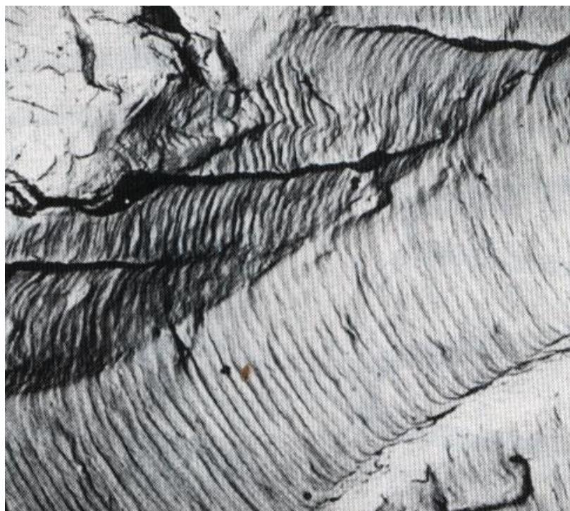
Obr.13.13. Mikrofotografie lomu hliníku (s charakteristickým žlábkováním).
