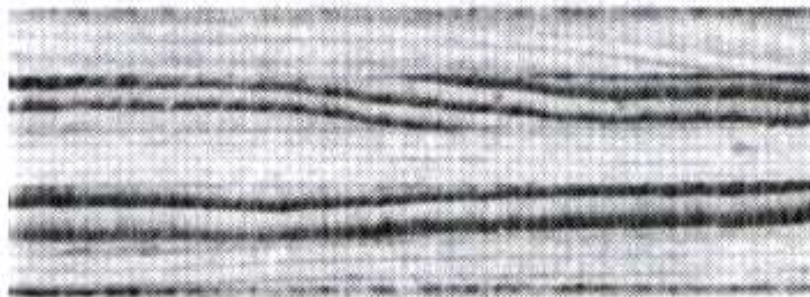
Obr.11.23. Jeden z nejznámějších laminárních kompozitů – dřevěná překližka.
