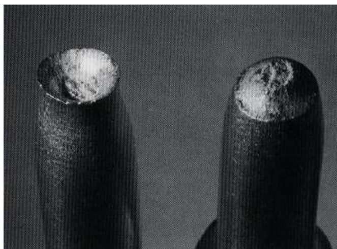
Obr.13.3. Typický tvárný lom (tvar čišky).
