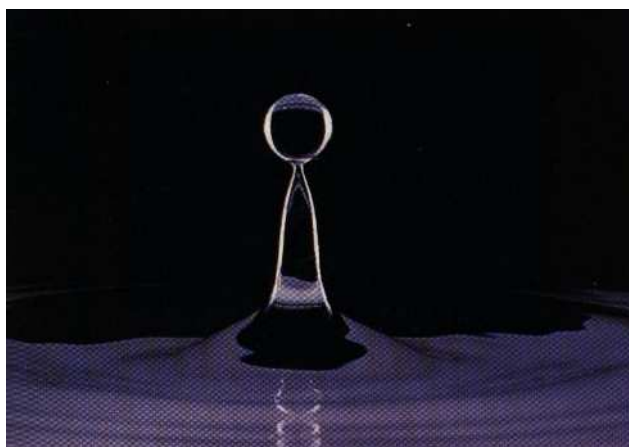
Obr.9.3. Tvar povrchu kapaliny v beztlížném stavu (po dopadu kapičky na povrch kapaliny vznikne v jistém kratičkém časovém intervalu tento tvar povrchu kapaliny. Síla tíhová je zde rovna síle setrvačné směrem nahoru a dochází pro tuto chvíli k beztlížnému stavu. Jedinou silou, působící na kapičku, je síla povrchového napětí).
