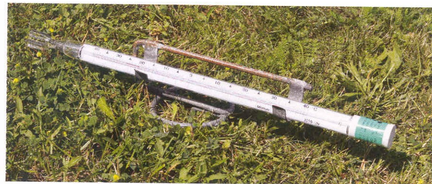
Obr. 1.5 Přízemní minimální teploměr, umístěný 5 cm nad zemí mimo meteorologickou budku, slouží k měření přízemní minimální teploty v době od 21 do 7 h (odečet v 7 h MSSČ)
