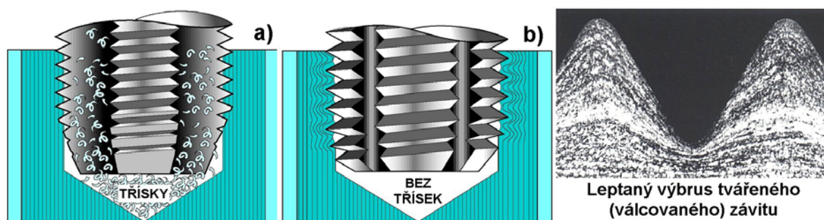
Obr. 5.20 Rozdíly při výrobě vnitřního závitu: a) řezací závitník, b) tvářecí závitník
