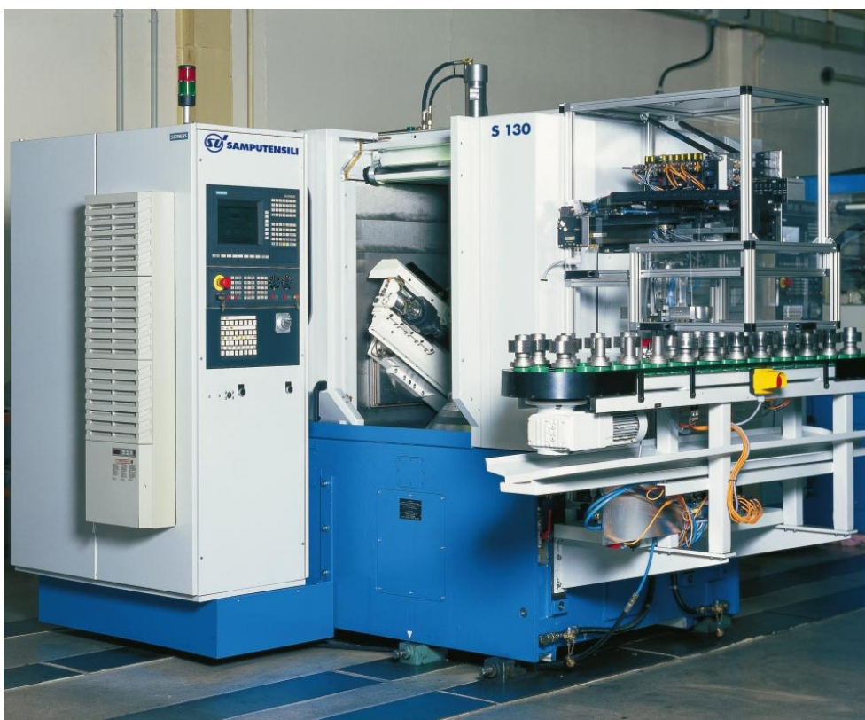
Obr. 6.11 Odvalovací frézka s CNC řízením
