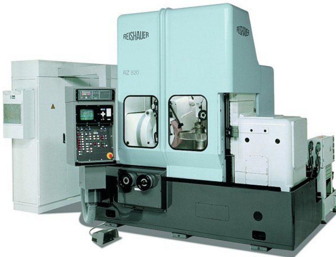
Obr. 6.27 Bruska pro odvalovací broušení ozubených kol
