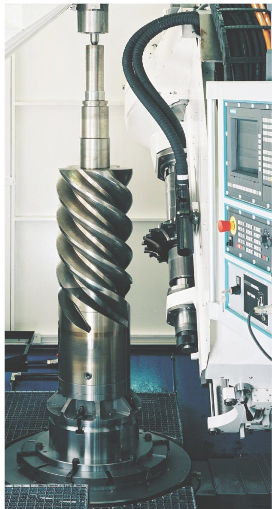
Obr. 6.41 Odvalovací frézování válcového šneku
