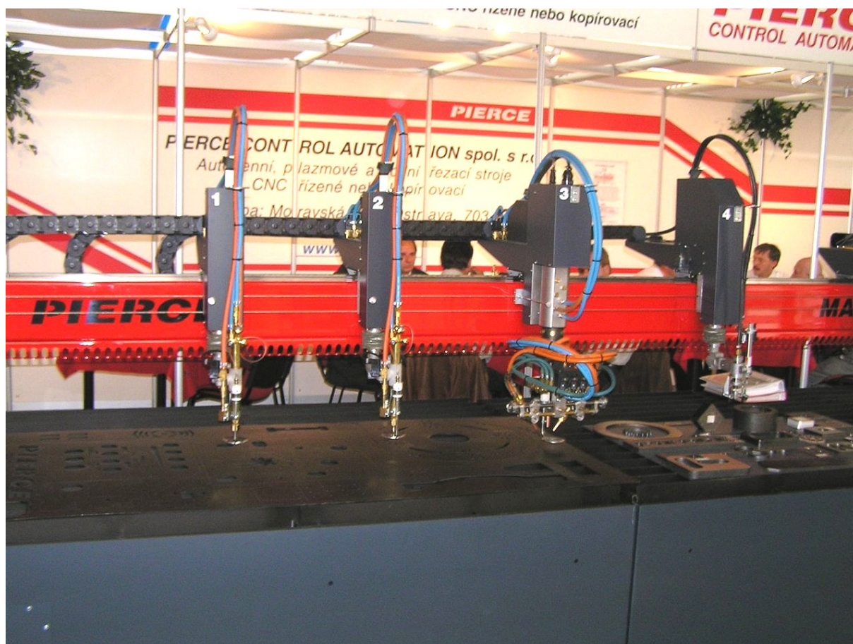
Obr. 7.6 CNC stroj MAXI 4500 pro řezání plamenem a plazmou
