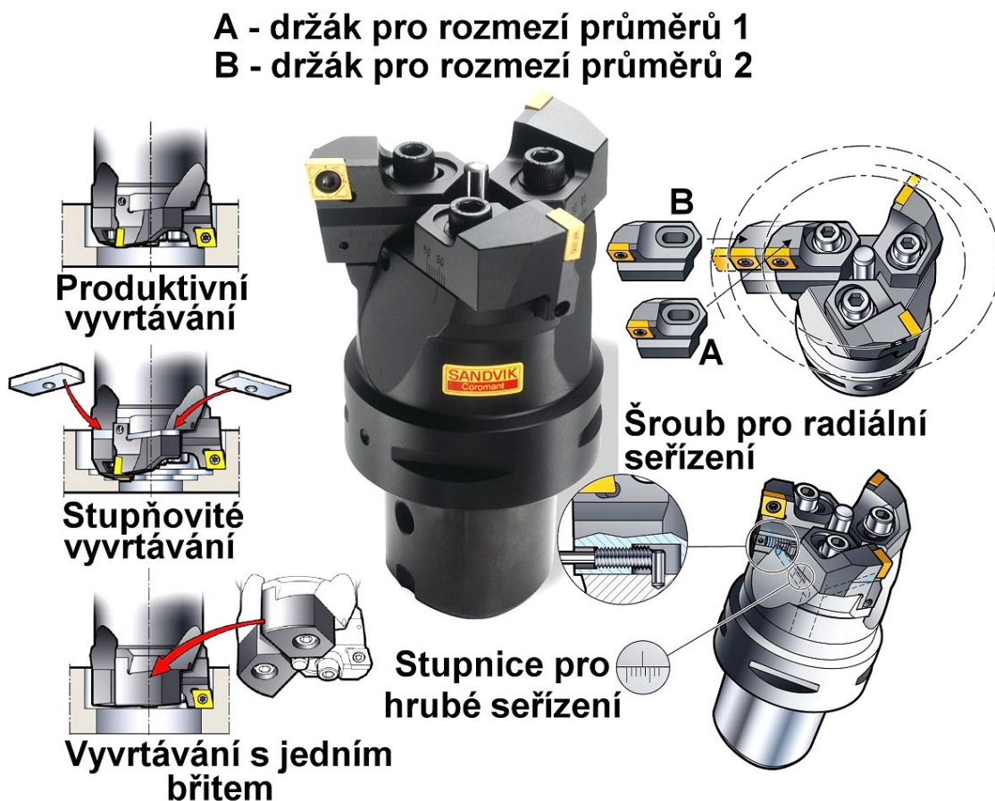
Obr. 2.10 Vyvrtávací nástroj CoroBore 820 firmy Sandvik-Coromant
