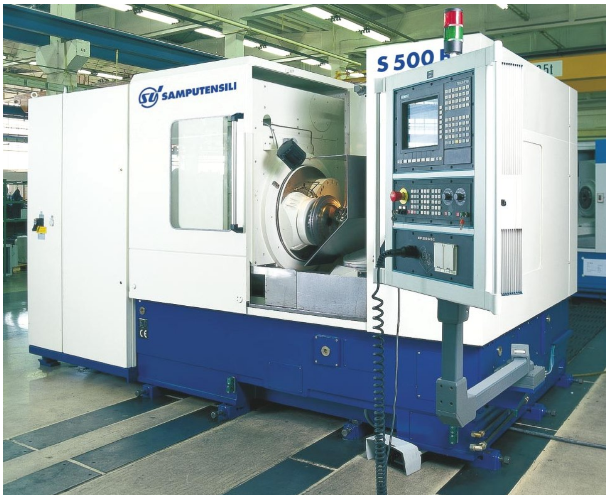
Obr. 6.35 Obráběcí stroj na výrobu kuželových kol s hypoidním ozubením
