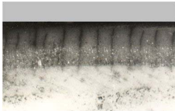
Obr.5.10 Hřebenovité trhliny na čele nástroje z řezné keramiky Al_2O_3
