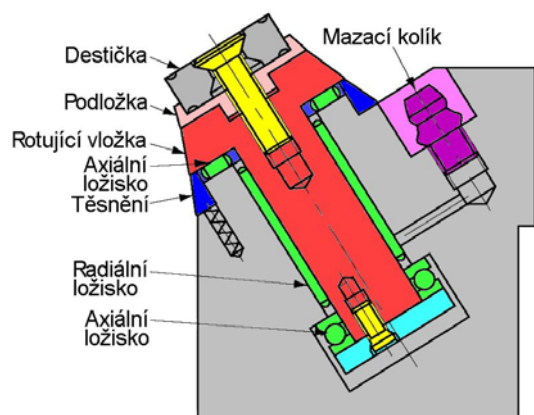
Obr.8.10 Upínání rotující destičky na noži firmy Mitsubishi
