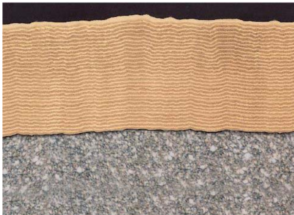
Obr. 6.12 Povlak 4. generace (Valenite, USA)
