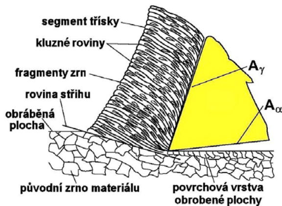
Obr.3.5 Změna textury materiálu
