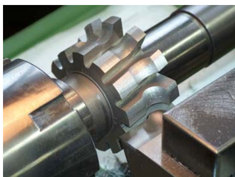
Obr.8.2 Podsoustružování hřbetu frézy
