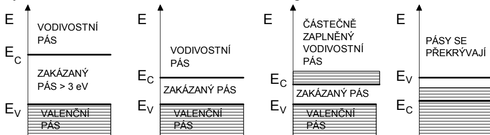
Obr. 1.6: Pásový model a) izolantu; b) polovodiče; c) monovalentního kovu; d) bivalentního kovu
