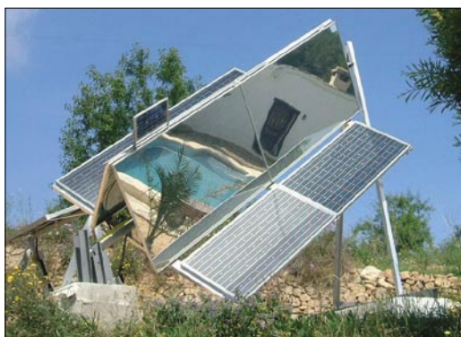
Obr. 9. PV solární systém 500 W s automatickým pohyblivým stojanem TRAXLE™ a s hřebenovým koncentrátorem záření (foto Steve Jasper)
