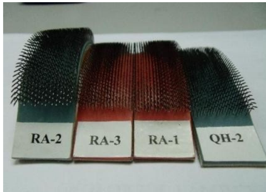
Příklady různých velikostí a tvarů mykacích hrotů (v praxi jsou umístěny na válcích)
