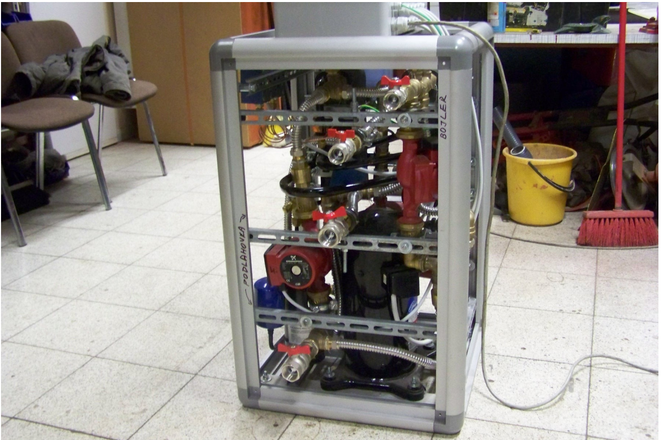
Obr. 5. Kompaktní jednotka – pohled ze strany vývodů pro podlahové topení a bojler.
