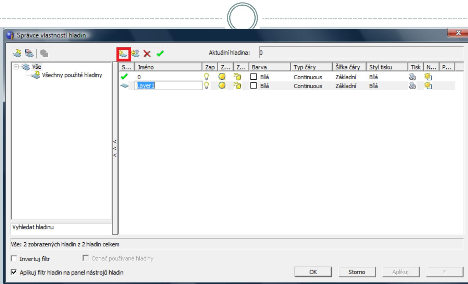
Umožňuje vytvářet **nové hladiny** a nastavovat u hladin *název, zapnutí/vypnutí, zmražení, zamčení, barvu, typ čáry, šířku čáry, nastavení tisknutí/netisknutí a další.*
