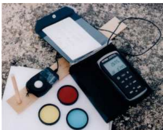
Obr. 2: Měřicí souprava: luxmetr, stínoměr, barevné fotografické filtry
