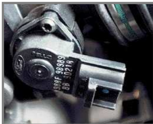
Obr. 3-3 Snímač polohy škrtící klapky (Ford Focus) [9]
