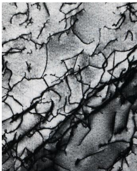
Obr.4.8. Elektronová transmisní mikrofotografie (titan).
