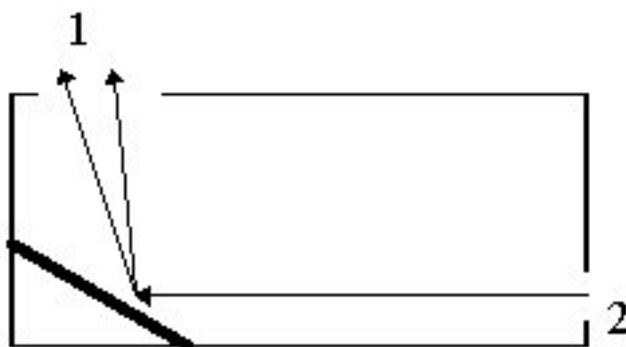
Obrázek 2.3: Schematicky zakreslená anatomie jednoduchého spektroskopu, s vyznačenými optickými dráhami paprsků.
