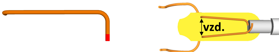
Obr8: vlevo - ohnutý vodič do tvaru L; vpravo - zatavení vodičů do kartáčku s dodržení potřebné vzdálenosti
