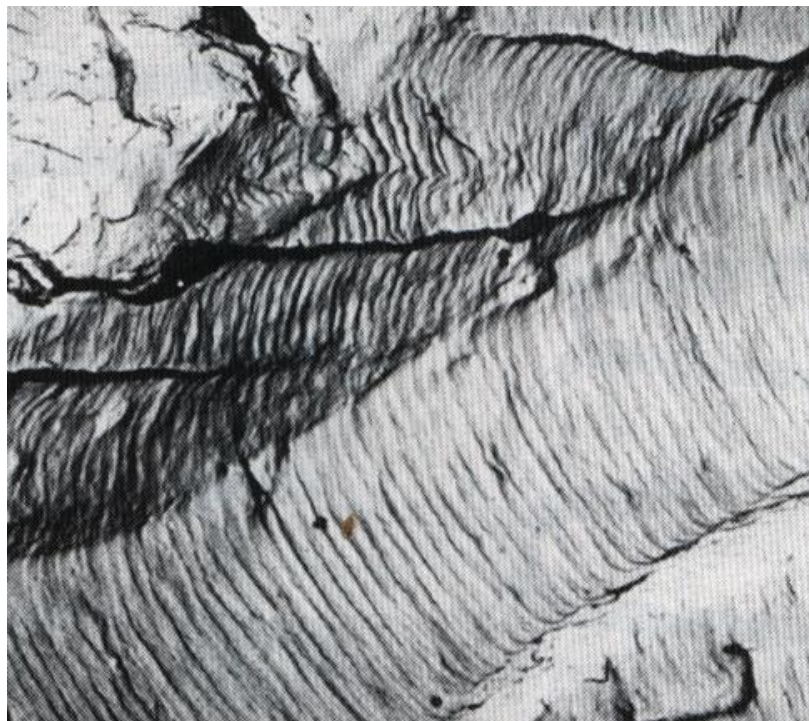
Obr.12.13. Mikrofotografie lomu hliníku (s charakteristickým žlábkováním) [ 2 ].
