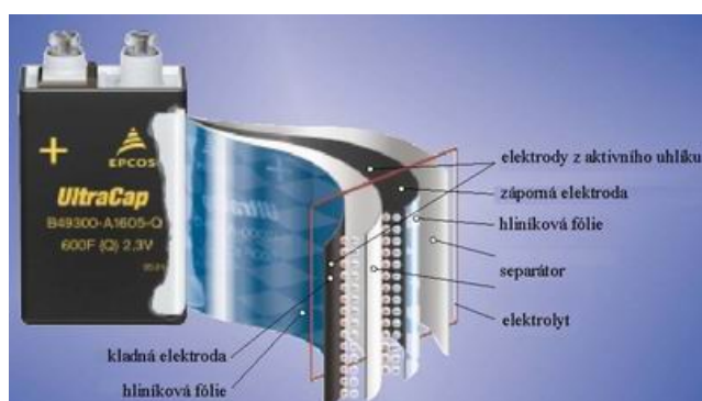
Obr. 1.8. Typická struktura superkondenzátoru
