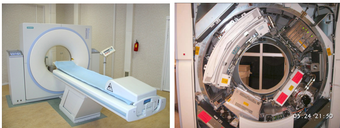
Obr. 6 Počítačový tomograf(CT) a pohled dovnitř portálu
