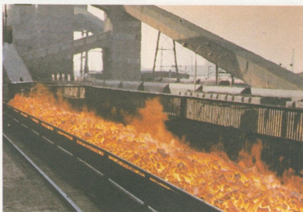
Obr. 120.1 Koksovací jednotka. Koks vytlačený z koksovacích komor je ještě žhavý
