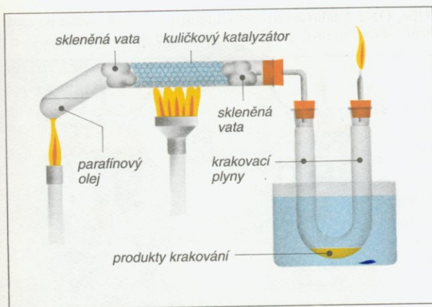
Obr. 116.2 Krakování parafinového oleje v přítomnosti katalyzátoru
