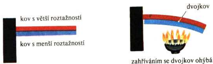
Obr. 4.13. Bimetal jako spínací prvek.
