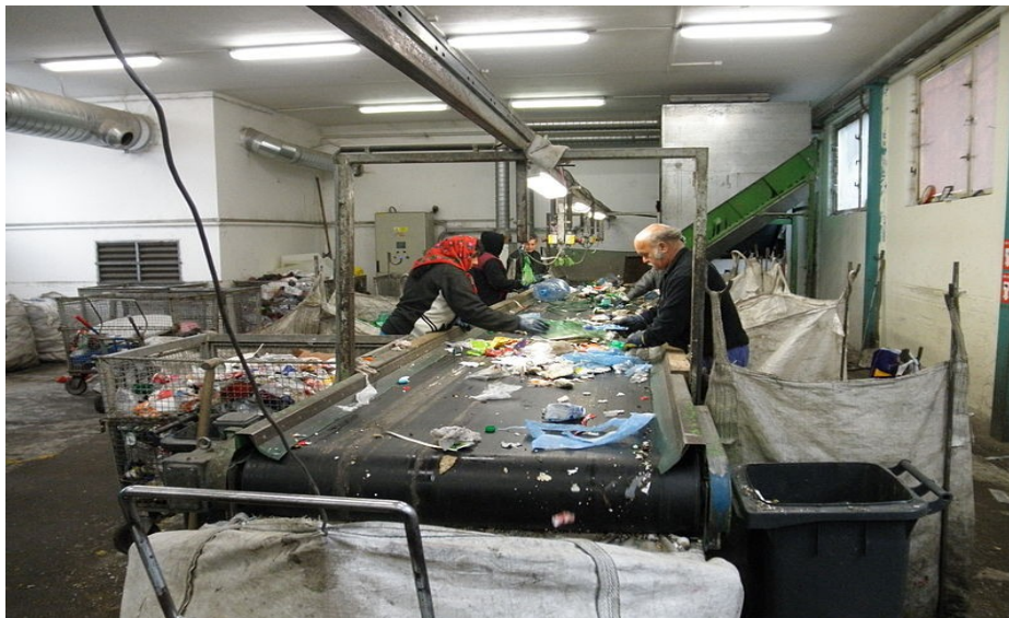
Obr.3.: Separační linka pro ruční třídění plastového odpadu.
