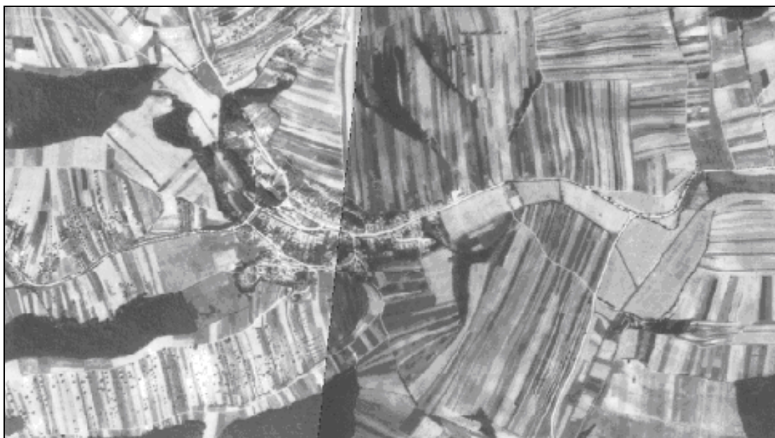
Obr. 7.4 Lícování (např. návaznost silnice) ortorektifikovaných snímků je velmi dobré, ale patrný velký rozdíl jasu barvy na obou snímcích
