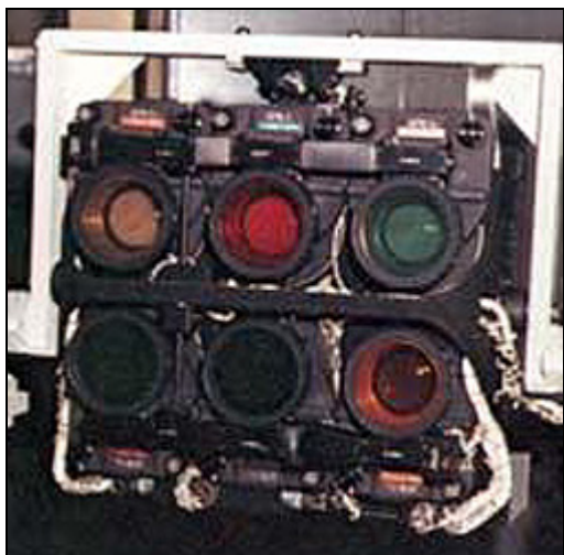
Obr. 2.13 Multispektrální kamera zaznamenává současně snímky z několika pásem spektra, zdroj [7].
