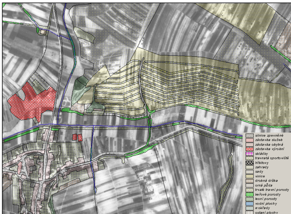
Obr. 7.7 Kombinace mozaiky zpracovaných archivních snímků s vektorovou vrstvou aktuálního využití krajiny. Z kombinace těchto dvou vrstev je patrné např. terasování svahů nebo výstavba výrobních zemědělských areálů.
