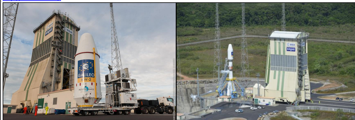
Obr. 9: Svrchní část určená nosné rakety Sojuz obsahující družici systému Galileo (vlevo). Příprava k vynesení družice systému Galileo na oběžnou dráhu s použitím rakety Sojuz (vpravo). Zdroj http://www.esa.int/
