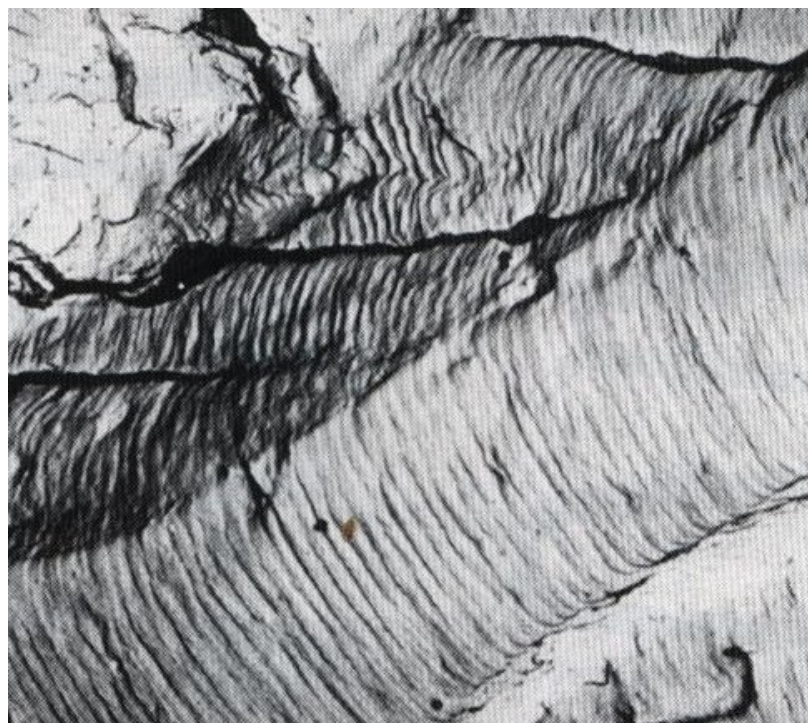
Obr.12.13. Mikrofotografie lomu hliníku (s charakteristickým žlábkováním) [ 2 ].
