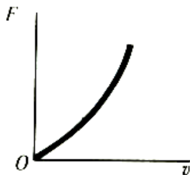
Obr. 8.13. Schematická závislost síly mokrého tření na rychlosti.
