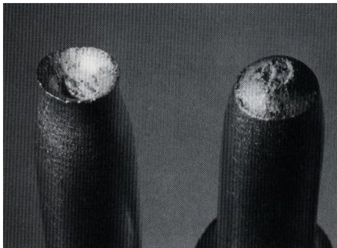
Obr.12.3. Typický tvárný lom (tvar číšky) [ 2 ].
