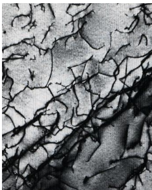
Obr.4.8. Elektronová transmisní mikrofotografie (titan).
