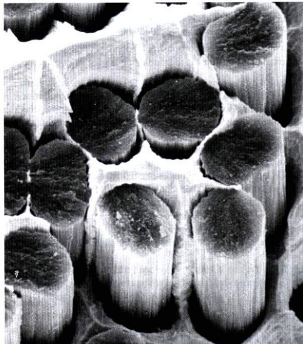
Obr.10.15. Slitina AgCu, zpevněná uhlíkovými vlákny.
