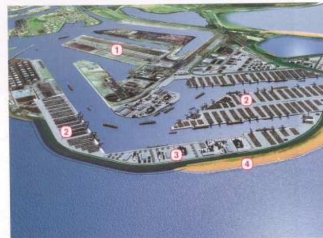
4 Le projet d'agrandissement du port : Maasvlakte II (image de synthèse, 2010) 1 Zone portuaire existante 2 Quais à conteneurs 3 Industries chimiques. 4 Digués
