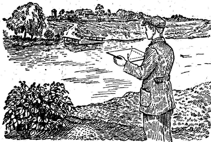
Obr. 17. Měření šířky řeky špendlíkovým přístrojem.
