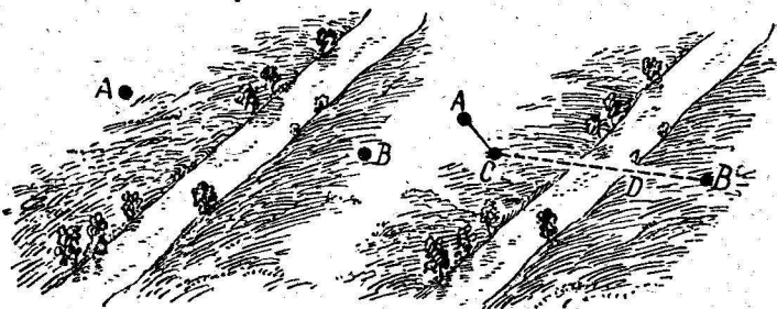
Obr. 36. Kde je třeba postavit most kolmý ke břehům, aby cesta z A do B byla nejkratší.
