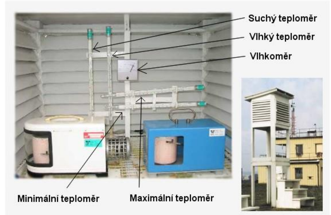
Obr.: Popis přístrojového zařízení meteorologické budky měřící teploty vzduchu Zdroj: metmladez.wz.cz – stránky zrušeny
