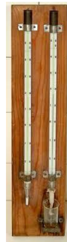
Měření vlhkosti vzduchu
