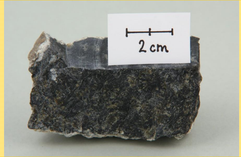
Skvrnitá stavba serpentinitu, staroměstská skupina, Raškov.
