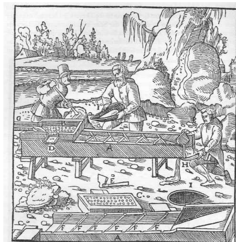
Das Gerinne A. Der Trog B. Sein umgekehrter Boden C. Sein seitlicher Auslaß D. Eine eiserne Krücke E. Die Brettchen F. Das Wassergerinne G. Der Sichertrog, in dem das, was sich abgesetzt hat, aufgefangen wird H. Ein Sichertrog, in dem es verwaschen wird I.
