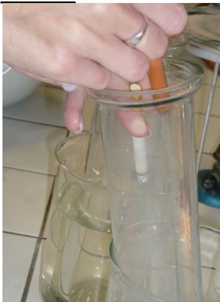
Obr. 13: Válec umístěný v teplé vodě – dým uniká ven
