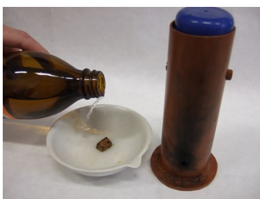
Obr. 2: Navlhčení korku benzinem
