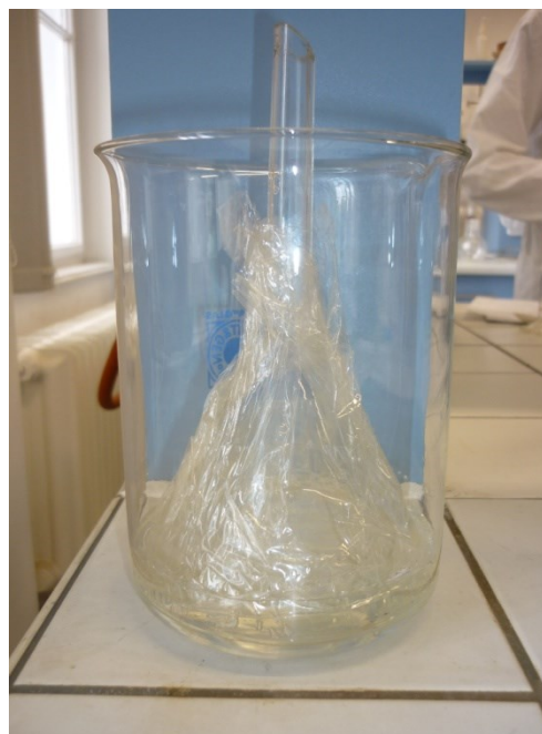
Obr. 6: Dialýza pře polopropustnou membránu - celofán
