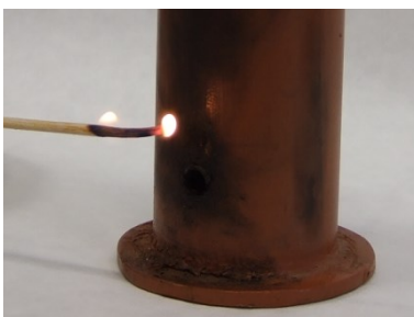
Obr. 5: Přiložení hořící špejle k otvoru
