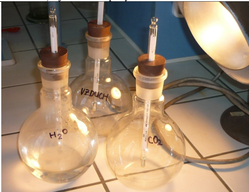
Obr. 16: Skleníkový efekt v laboratoři
