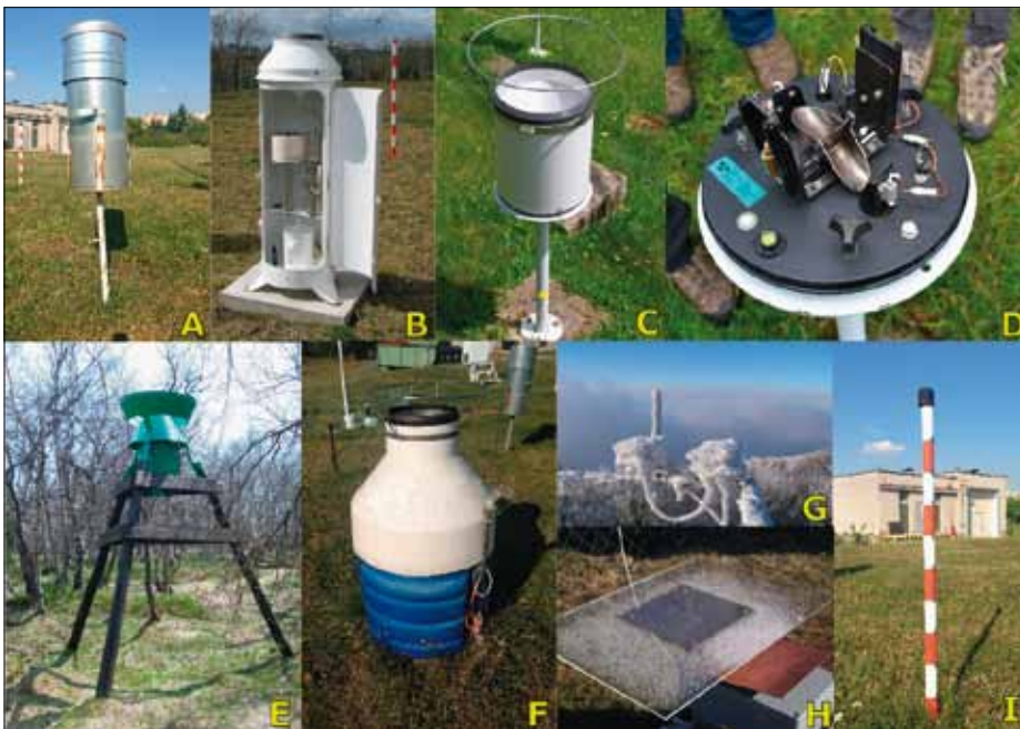
Měřicí přístroje: A manuální srážkoměr, B ombrograf (starý typ přístroje měřící intenzitu srážek – opatřen válcem s papírovou páskou, kam se pomocí inkoustové špičky zapisovala křivka napadaných srážek do nádoby, která je přes komoru s plovákem spojená s registračním perem), C automatický člunkový srážkoměr, D vnitřní část člunkového srážkoměru, E totalizátor, F váhový srážkoměr, G námrazoměr, H rosoměr, I sněhoměrná lať
