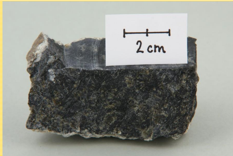
Skvrnitá stavba serpentinitu, staroměstská skupina, Raškov.
