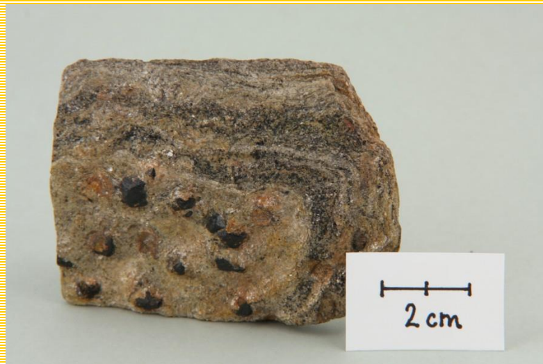
Plošně paralelní – břidličnatá stavba svoru, Zlatý Chlum.
