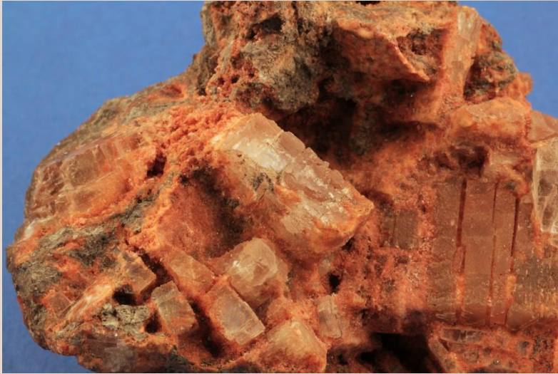
Krystaly dokonale štěpného anhydritu povlečené hydroxidy železa.
