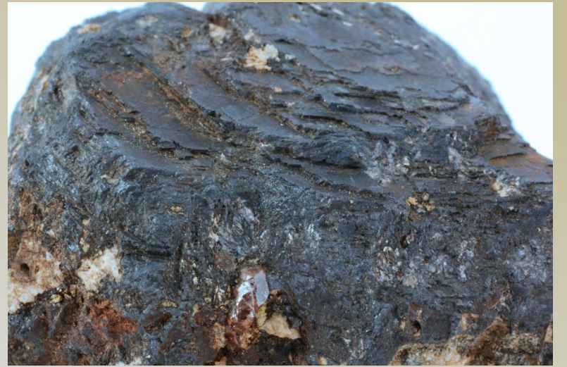
Hrubě zrnitý agregát ilmenitu s dobře patrnou odlišností, tmavě ocelově šedou barvou.
