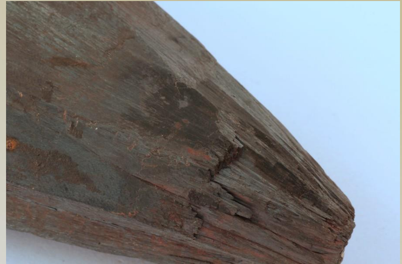
Radiálně paprčité uspořádání lebníkovitého hematitu s hnědočernou barvou a matným leskem.
