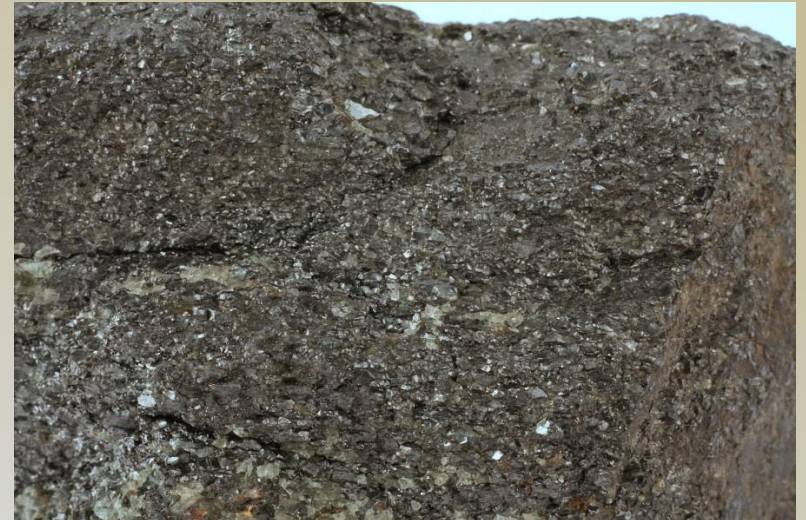
Jemně zrnitý agregát černého, polokovově lesklého magnetitu, Falun.
