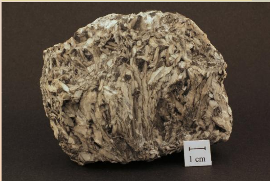
Zrnitý agregát magnezitu - Sunk
