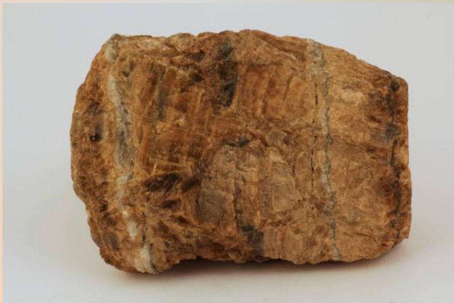
Hrubě zrnitý agregát sideritu - Příbram
