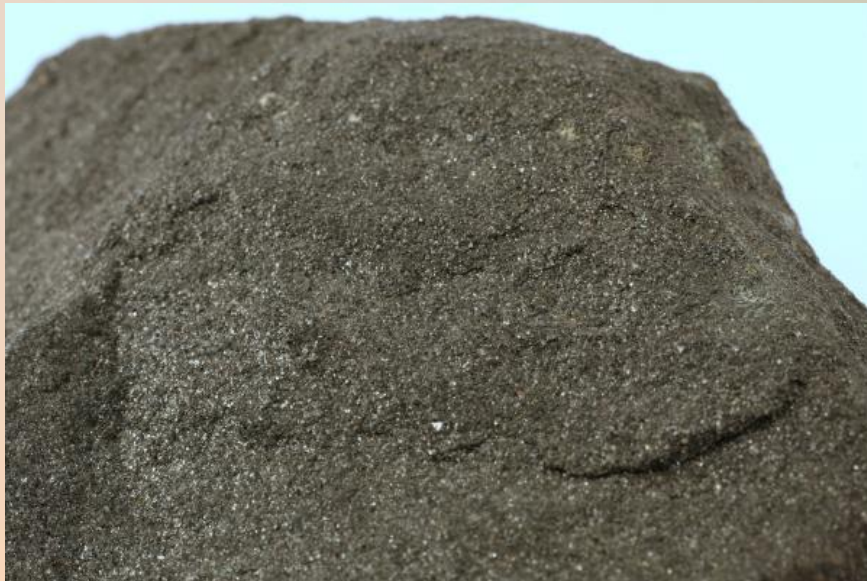
Jemně zrnitý agregát magnetitu - Měděnec
