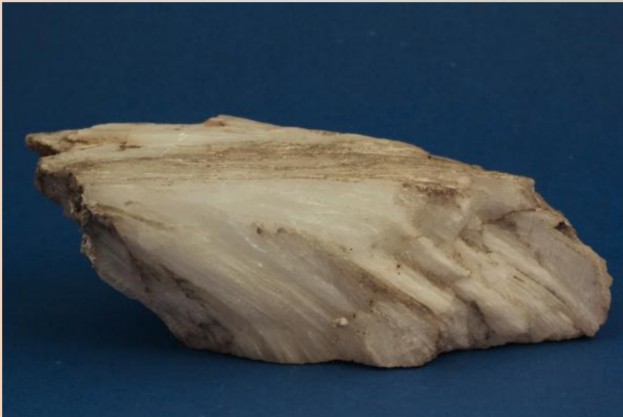
Vláknitý agregát sádrovce (selenit) - Niwnice
