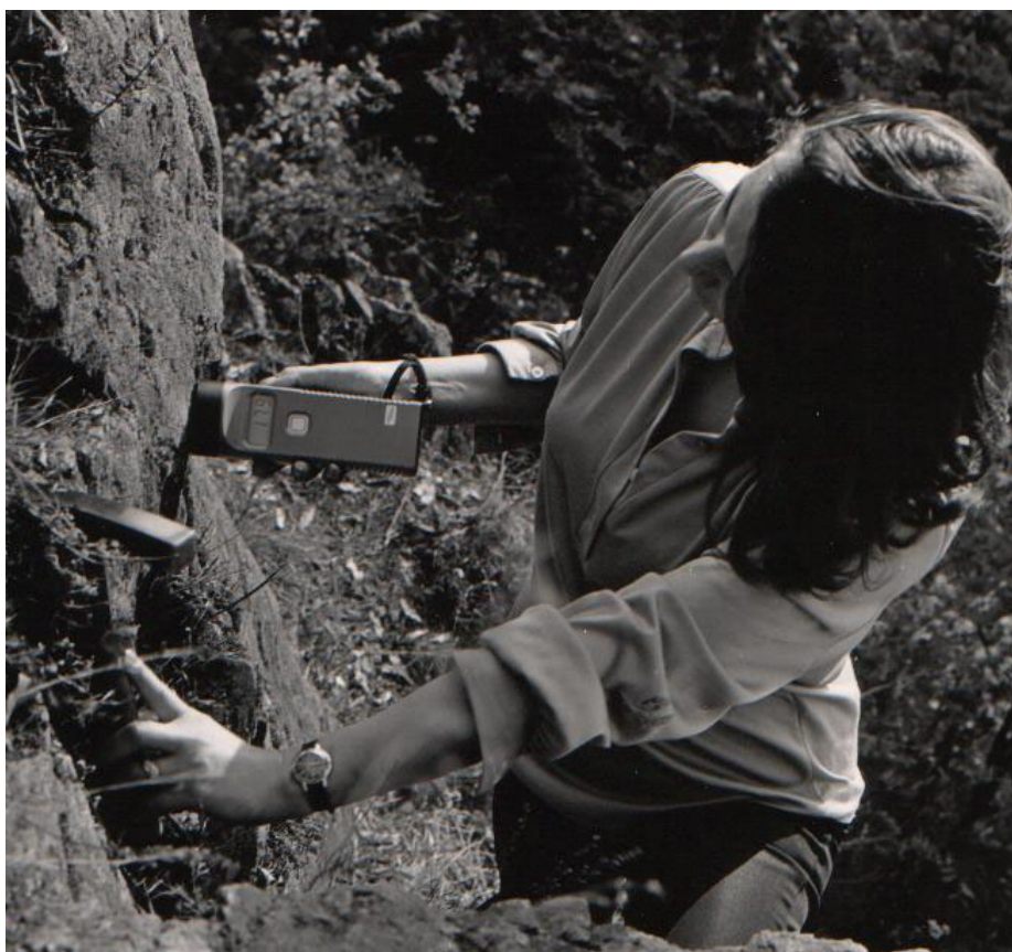
Měření magnetické susceptivity hornin kapametrem
