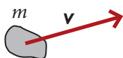
Obrázek 5-2. Hybnost tělesa je vektorová veličina určená součinem hmotnosti tělesa a jeho rychlosti.
