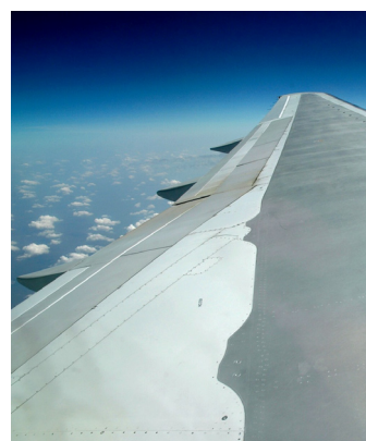
Obrázek 8-17. Takto můžete vidět křídlo letadla Boeing 777 přímo z jeho paluby. Proudící vzduch právě na toto křídlo musí působit aerodynamickou vztlakovou silou přes 1000000N, neboť celé letadlo váží přes 200 tun.
