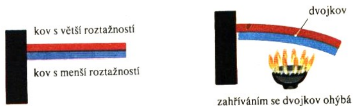
Obr. 4.13. Bimetal jako spínací prvek.
