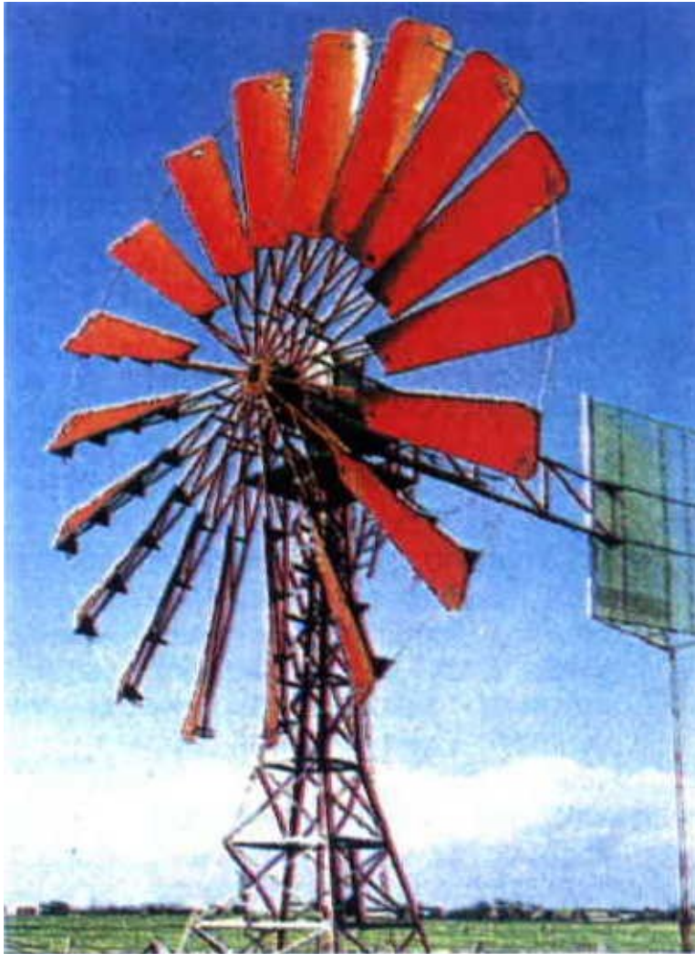
Langsam, dafür hohes Drehmoment: Die amerikanische Windmühle.
