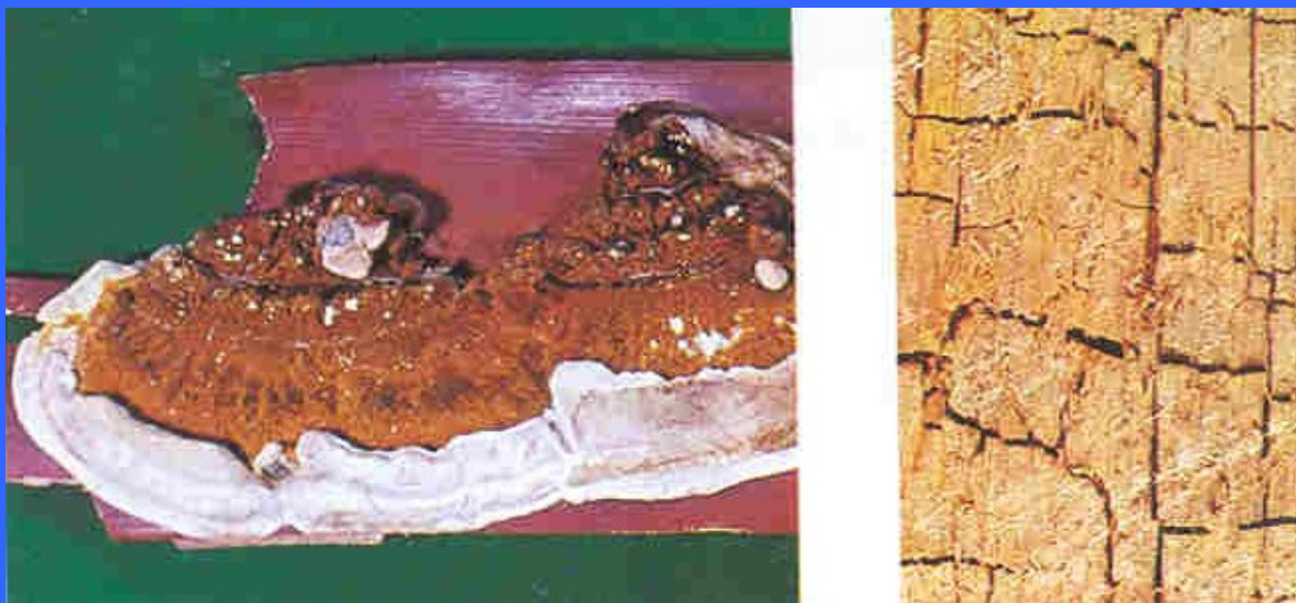
Dřevomorka domácí (vpravo jí způsobená škoda)
