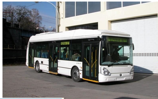
Autobus na vodíkový pohon, který od roku 2006 vyvíjí Ústav jaderného výzkumu v Řeži u Prahy
