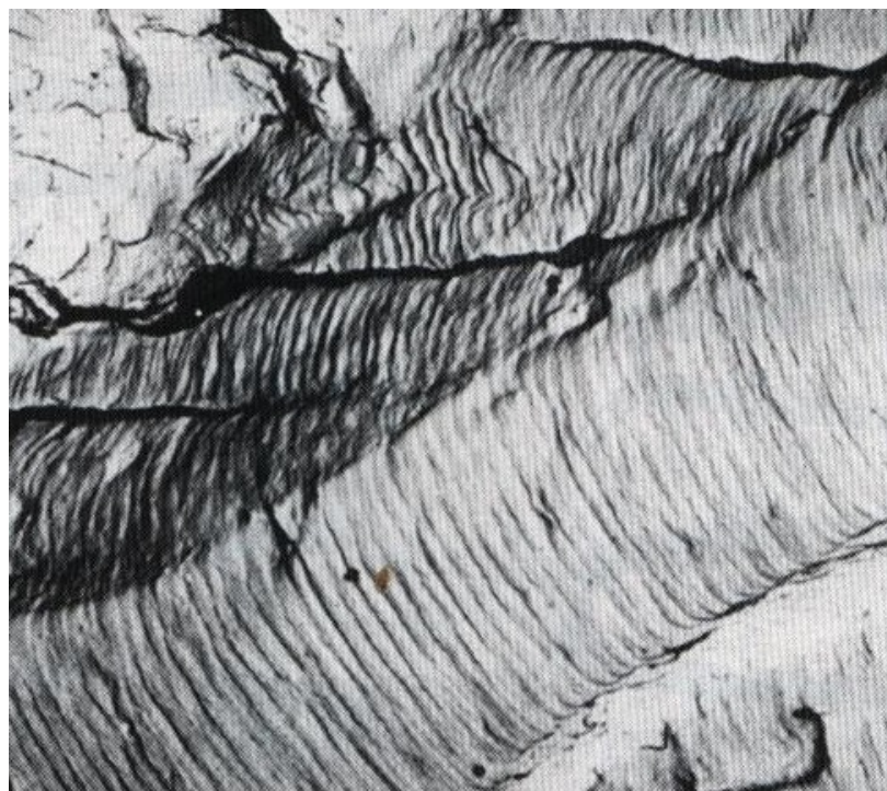
Obr.12.13. Mikrofotografie lomu hliníku (s charakteristickým žlábkováním) [ 2 ].
