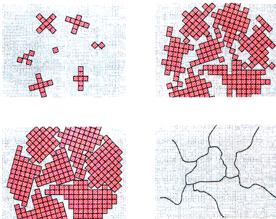
Obr.3.11. Vznik polykrystalů (tuhnutím)
