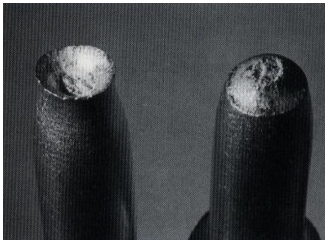
Obr.12.3. Typický tvárný lom (tvar čišky) [ 2 ].
