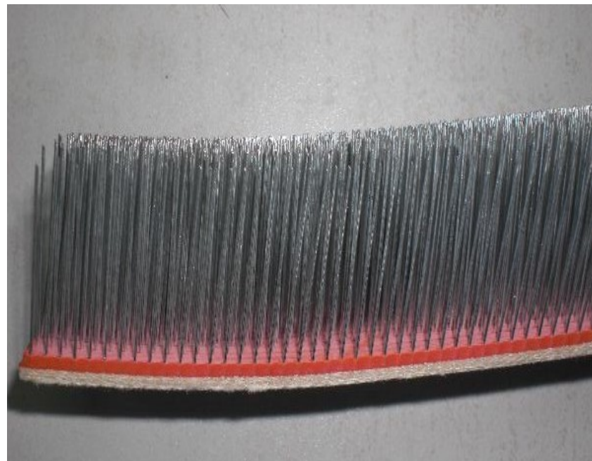
Příklady různých velikostí a tvarů mykacích hrotů (v praxi jsou umístěny na válcích)
