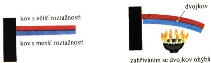
Obr. 4.13. Bimetal jako spínací prvek.
