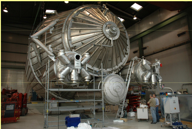
Testy a přeprava hlavní vakuové komory spektrometru KATRIN
