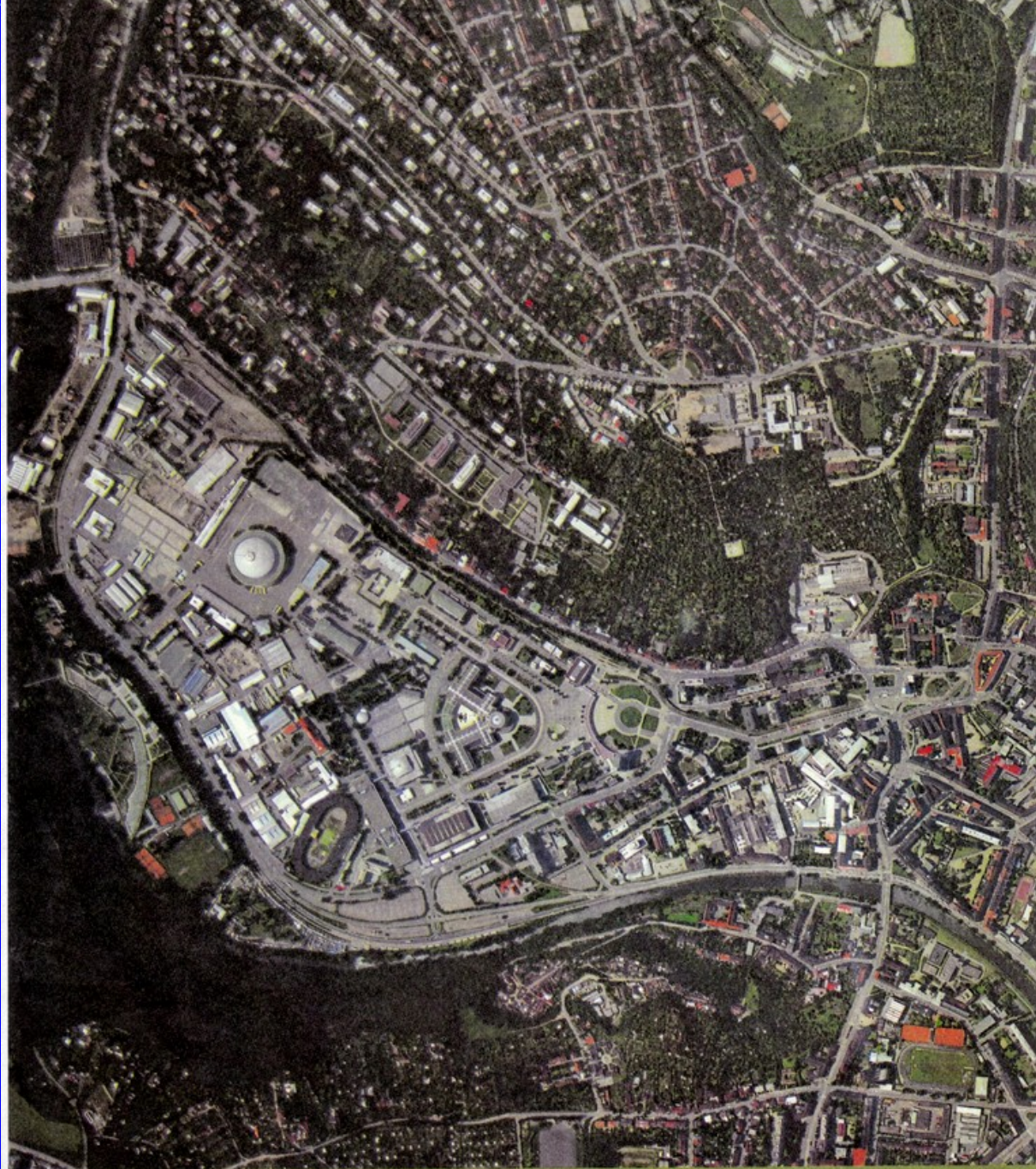
Kamera ZEISS RMK A 15/23, film AGFA AVICOLOR NP 200, výška letu 4200 metrů ( f = 150 mm) město Brno – kolmý snímek
