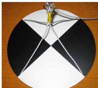
Obr. 2: Secciho deska pro zjišťování průhlednosti vody [49]
