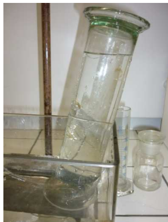
3. – 4. Vzniká bezbarvý oxid dusnatý NO, který postupně vytlačuje vodu z válce
