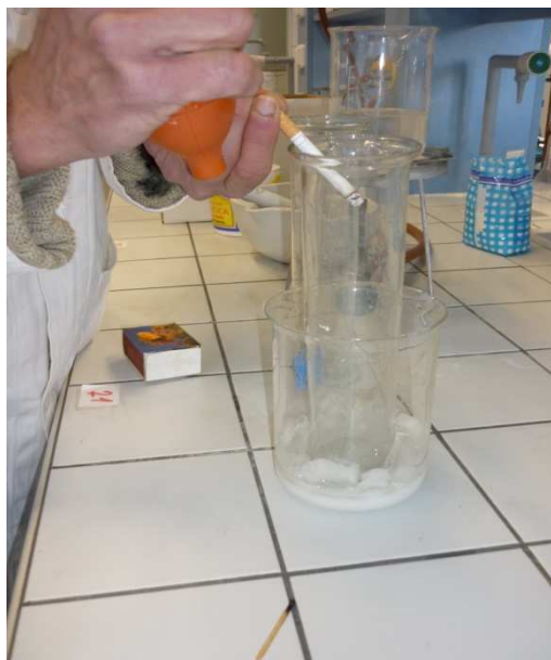
Obr. 14: Válec umístěný v chladicí směsi – dým se hromadí u dna
