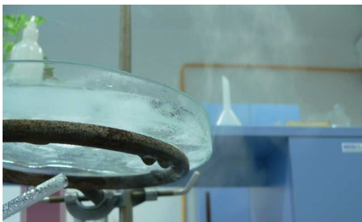
Obr. 4: Kondenzace vodní páry
