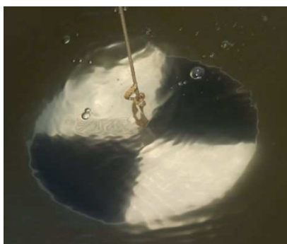
Obr. 3: Secciho deska při zjišťování průhlednosti vody v rybníku [50]
