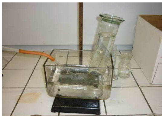
3. – 4. Vzniká bezbarvý oxid dusnatý NO, který postupně vytlačuje vodu z válce
