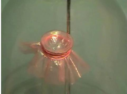
*Gumová blána nebo plastová fólie napodobuje chování ušního bubínku během plavání, koupání a potápění. Voda v uchu (ušním zvukovodu) tlačí na ušní bubínek stejně jako v případě našeho experimentu vzduch. Výsledkem tlaku je deformace ušního bubínku a v případě velkého tlaku (přetlaku) jeho protržení.*
