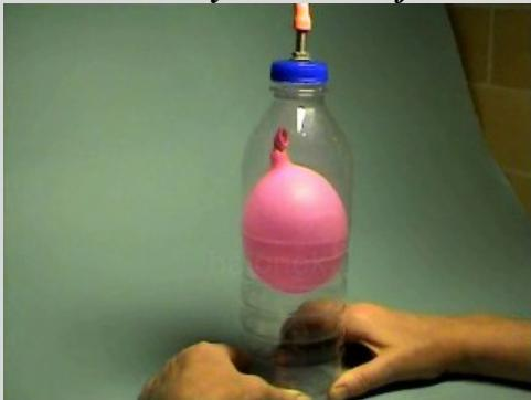
► Přetlak v láhvi vyvolaný pumičkou způsobí zmenšení objemu balónku.
