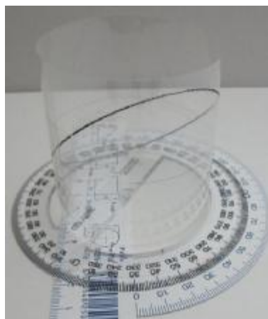
Obr. 5: Lissajousova křivka poměr frekvencí 1:1 pro fázový posun 30^\circ
