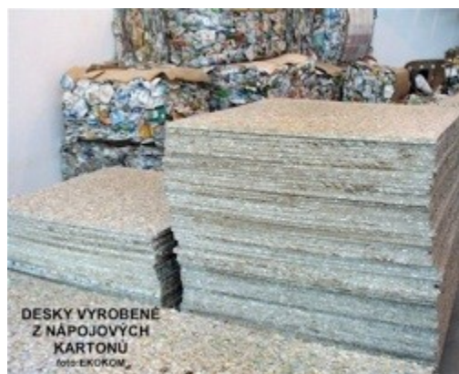
Obr. 9.: Izolační desky vyrobené z TetraPack obalů
